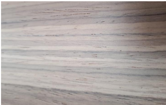
Фото «открытой поры» после отделки ЛКМ
